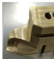
**5軸加工機・超音波加工機 加工事例**
