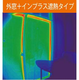
(株)LIXIL社内試験試験ボックスを室内と想定し、サッシ屋外側表面温度が70℃になるように人工的熱線照射100分間を加えた試験結果。
